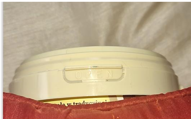
Rysunek 13: Przykład zamknięcia zabezpieczonego przed manipulacją
